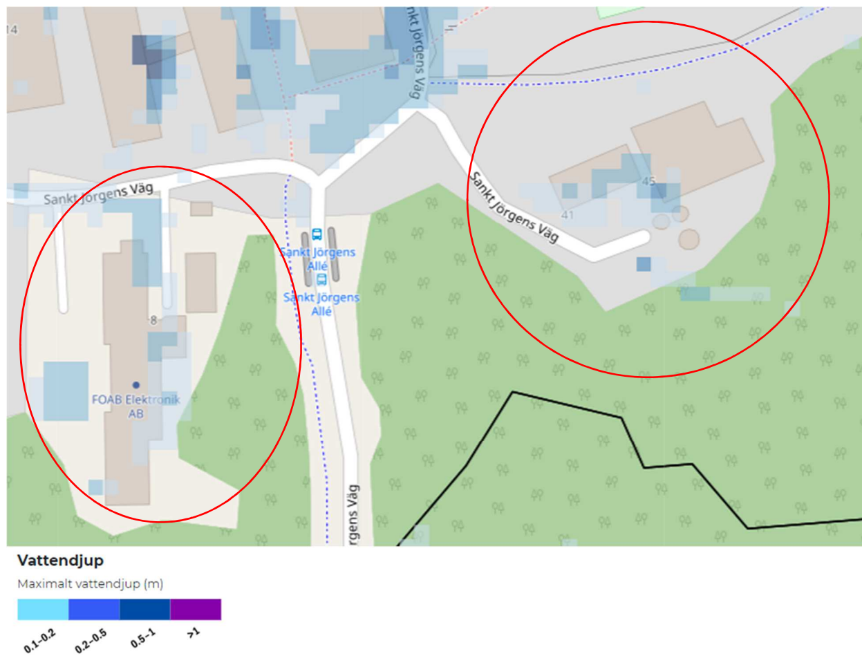
Figur 16. Bilden visar instängda områden i områden, Områdena översvämmas vid ett skyfall och har ett vattendjup mellan 0,1–0,5 m.
